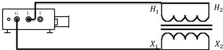
Figura 2.1.2 diagrama de conexiones para prueba de resistencia de aislamiento entre las terminales de alta y baja tensión
