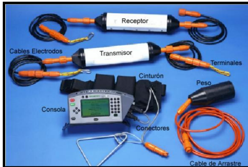
Figura (27).- Componentes del OhmMapper
