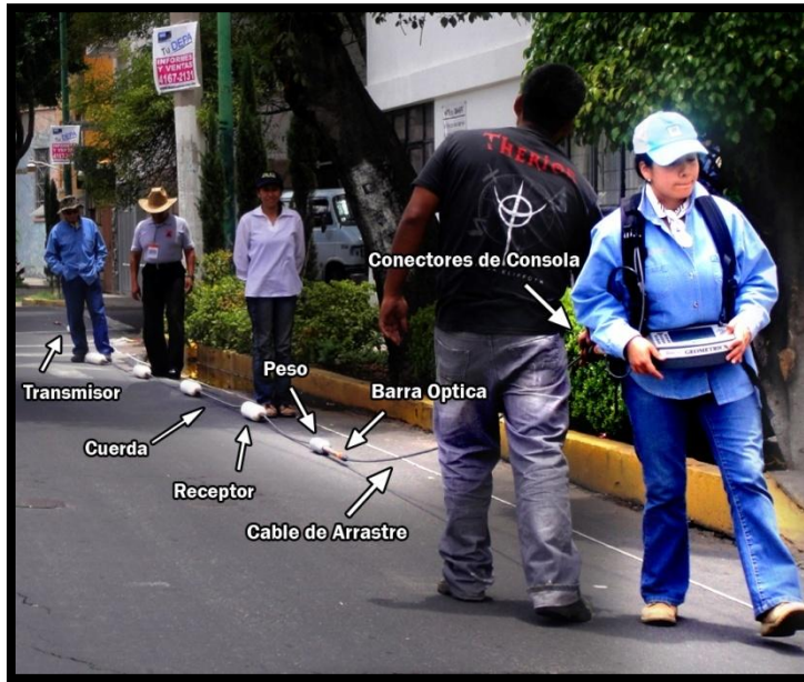
Figura (29).- Montaje del Equipo.
