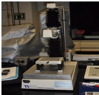
**Figura 20. Texturómetro TX-XT2**
