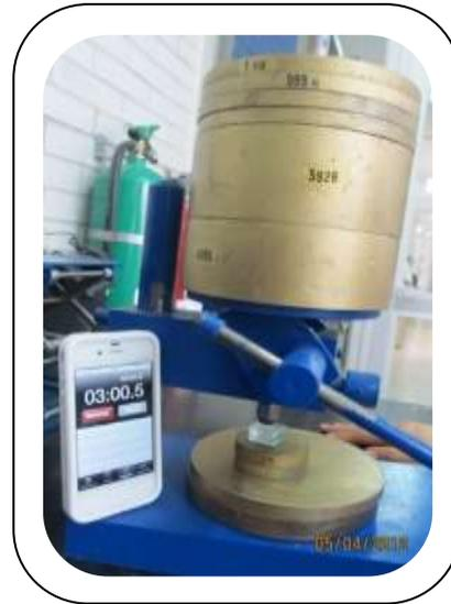
**Fig. 19:** Se colocaron a los 3 minutos 15Kgf sobre las placas de vidrio. <sup>(Fd)</sup>
