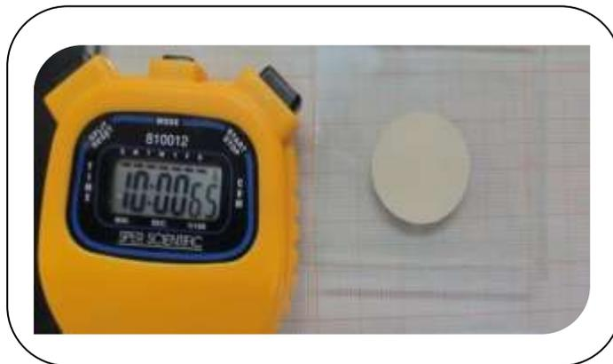
**Fig. 11:** Diámetro formado después de retirar el peso a los 10 min<sup>(Fd)</sup>
