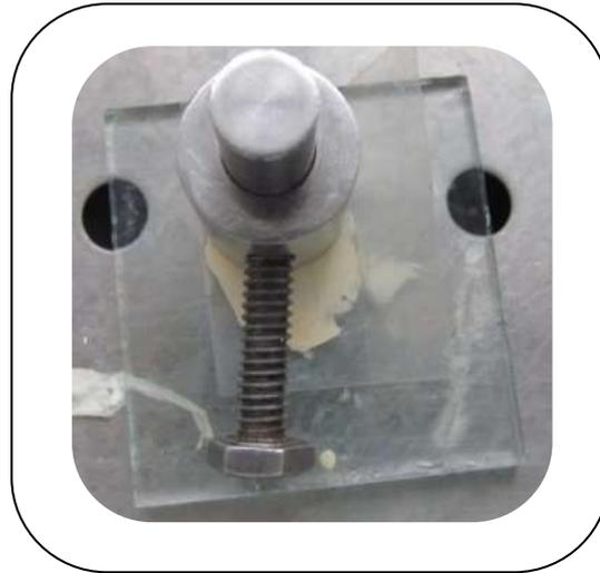
**Fig. 47:** Moldes con el cemento mezclado y llevado a la cabina por tres veces el tiempo de endurecimiento. <sup>(Fd)</sup>
