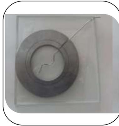
**Fig. 33:** Molde con medidas de 1.5 mm de grosor y 20 mm de diámetro interno, se le adaptó un alambre.<sup>(Fd)</sup>
