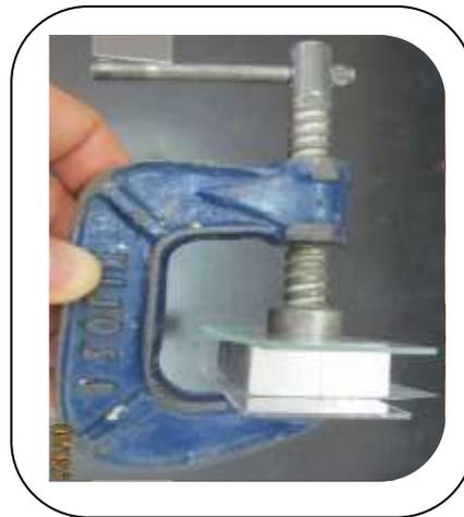
**Fig.28:** Prensa en C presionando el molde con el cemento.<sup>(Fd)</sup>
