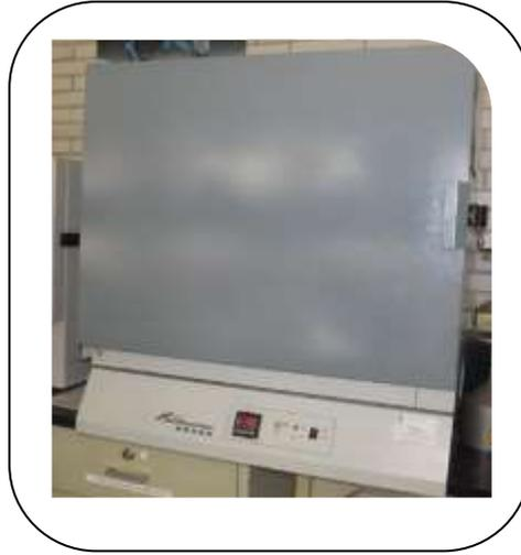
**Fig. 39:** Fueron almacenados en el gabinete a una temperatura de  $37 \pm 1^\circ\text{C}$  por 24 horas. <sup>(Fd)</sup>
