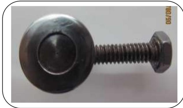
**Fig. 46:** Molde de anillo con diámetro interno de 10 mm y 1 mm de ancho. <sup>(Fd)</sup>
