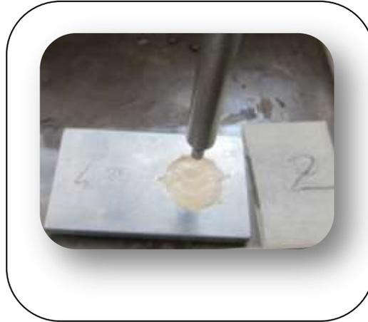
**Fig.24:** Se baja la aguja tipo Gillmore verticalmente sobre la muestra a los 50 minutos establecidos por el fabricante como tiempo de endurecimiento.<sup>(Fd)</sup>
