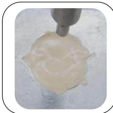
**Fig. 25:** No se observan indentaciones sobre la superficie del material.<sup>(Fd)</sup>
