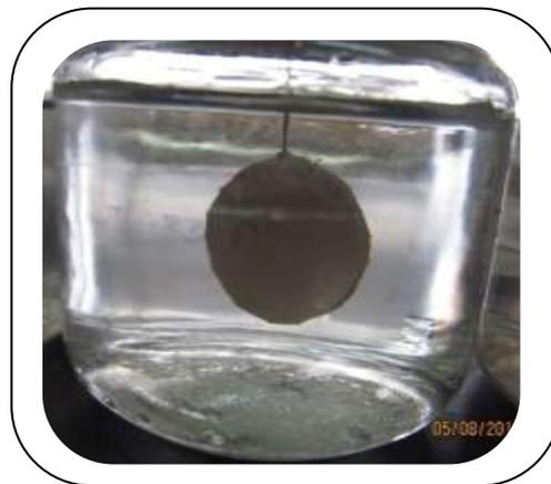
**Fig. 38:** Colocación de los especímenes suspendidos dentro de los frascos con 50 ml de agua bidestilada. <sup>(Fd)</sup>
