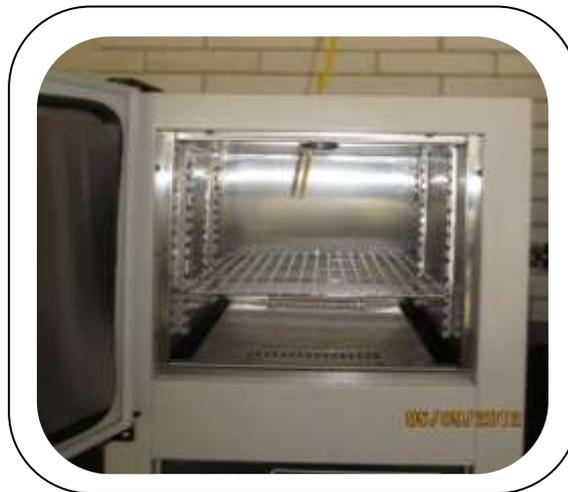
**Fig. 42:** Horno a 110 °C <sup>(Fd)</sup>
