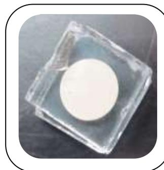
**Fig. 18:** Se centró la segunda placa de vidrio sobre el cemento.<sup>(Fd)</sup>
