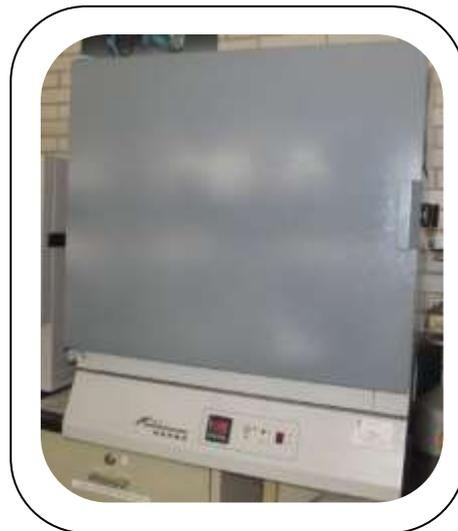
**Fig. 32:** En la cabina permanecieron las muestras a  $37 \pm 1$  °C, durante treinta (30) días y se volvieron a medir los especímenes. <sup>(Fd)</sup>
