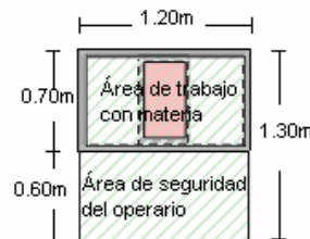
Figura II.30 Área de seguridad propuesta para el operario y del área de trabajo con material de la máquina caladora de mesa
