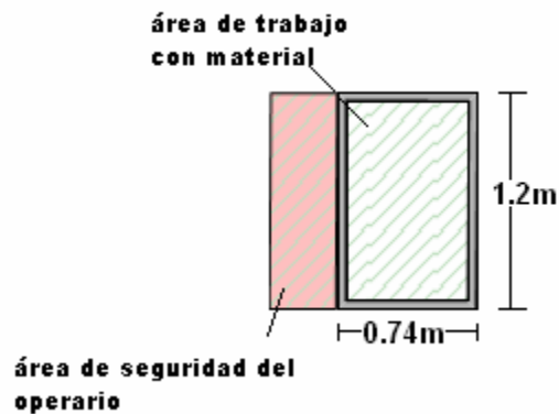
Figura VI.3 Se Área de seguridad del operario y de trabajo con material para la soldadura de oxiacetileno
