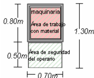
Figura II.13 Área de seguridad propuesta para el operario y del área de trabajo con material de la máquina taladro de columna
