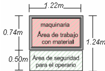
Figura II.11 Área de seguridad propuesta para el operario y del área de trabajo con material de la máquina torno para madera
