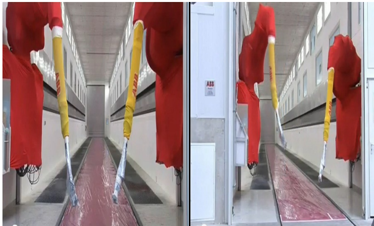
Figura 2.1: Cámara de aplicación de recubrimiento y secado de aspas de la empresa Enercon, automatizada por dos robots ABB articulados servocontrolados.
