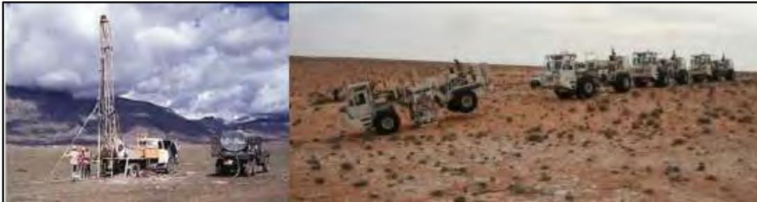
Figura 4.15\_ Fotos que muestran la perforación de un pozo para colocar dinamita y un camión Vibroseis (Tomado de [http://www.mttmlr.com/sismologia\\_files/](http://www.mttmlr.com/sismologia_files/), 2010).
