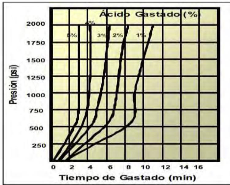
Figura 5.13\_Efecto de la presión sobre el tiempo de reacción del HCL-CaCO<sub>3</sub> (Tomado de PEMEX, 2008).
