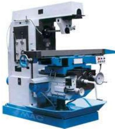
*Figura 1.9. Fresadora horizontal*
