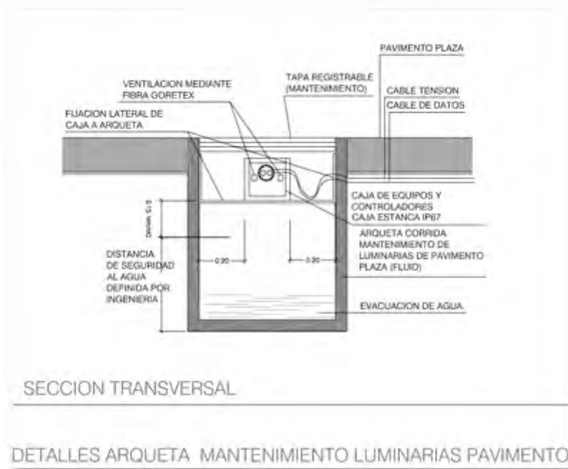
Detalle de luminarias.
