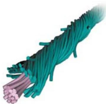
**FIGURA 24** Hilo Vortex mostrando los filamentos para formar la fibra
