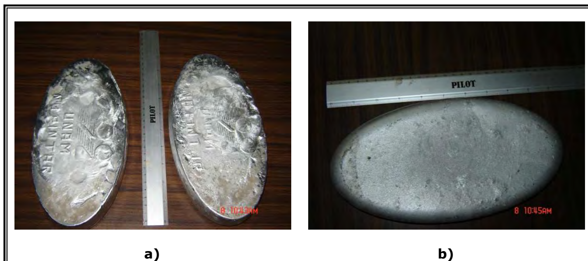
Figura 4.2. Ánodo F.Q. fabricado con el propósito de reproducir, la aleación con mejores características para la protección catódica.
