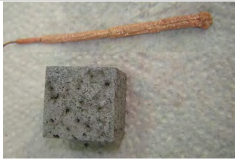
Figura 3.12. Condiciones de probetas después del ensayo NACE, aleación F.Q.
