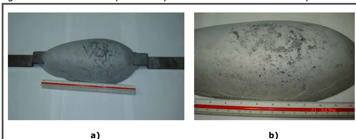
Figura 4.1. Ánodo I.M. fabricado para la protección catódica del buque naval.
