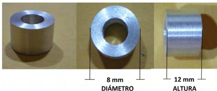
Figura 3.3. Dimensiones del electrodo de trabajo del cilindro rotatorio.
