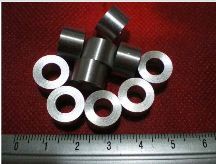
Figura 3.6: Probetas para las pruebas de flujo turbulento, en electrodo de cilindro rotatorio.
