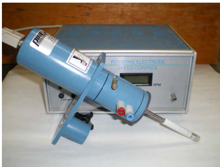
Figura 3.4. Equipo del electrodo de cilindro rotatorio, motor, vástago y controlador de velocidad.
