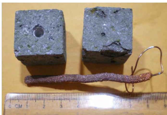
Figura 4.33. Condiciones de la probetas después de medición de eficiencia electroquímica.
