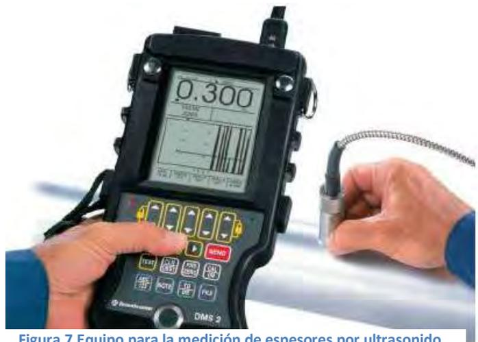
Figura 7. Equipo para la medición de espesores por ultrasonido
