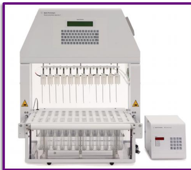
Figura 11. Aparato de disolución USP 7: Soporte Oscilante
