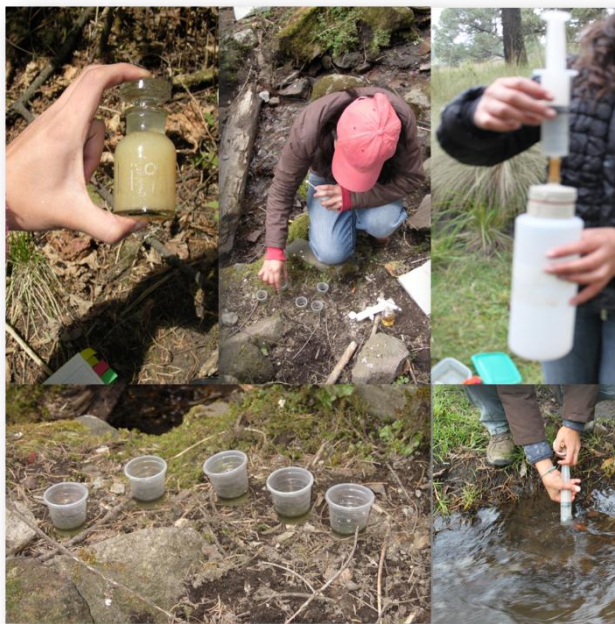
Figura 7. Determinación de oxígeno disuelto en campo y toma de muestra para carbono orgánico particulado.
