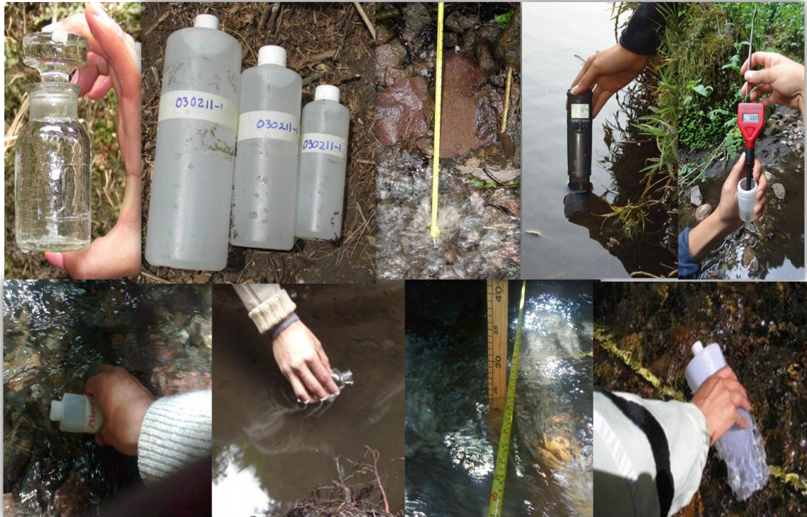
Figura 6. Toma de muestra de agua, temperatura, conductividad eléctrica, pH y medición de perfil batimétrico.
