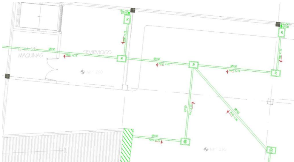
Distribución de ramal en sótano para salida a red municipal, bajada de aguas negras y registros
