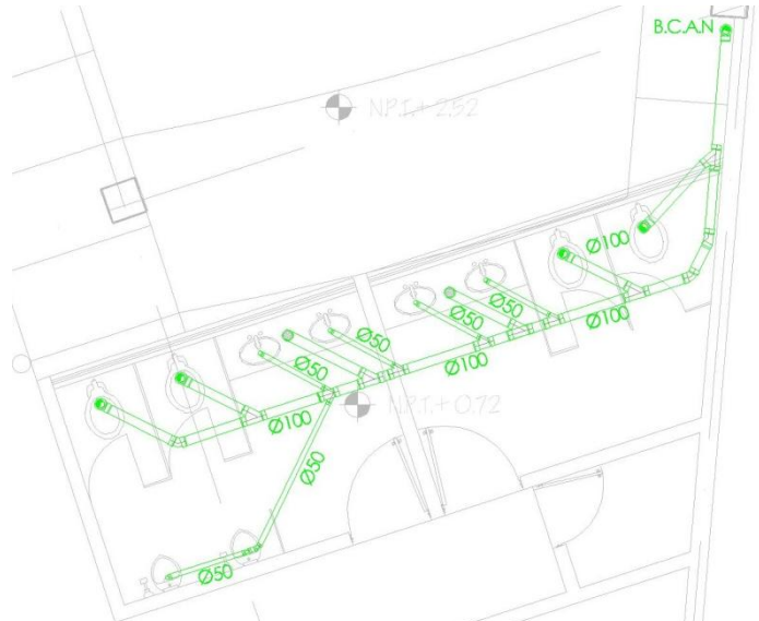
Los diámetros de la lavabos son de 2", el diámetro de wc y coladeras son de 4" el desagüe hacia la bajada de agua es de 4"
