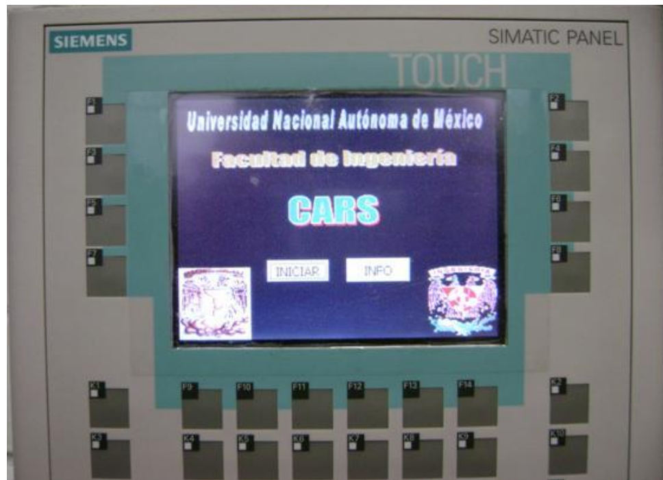
Figura F.47. Panel de operador con programa cargado.
