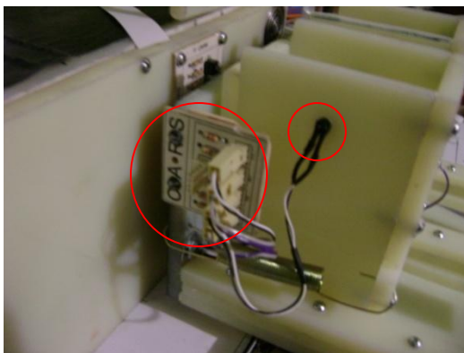
Figura 5.22. Placas de circuito impreso para detección de contenedor lleno.
