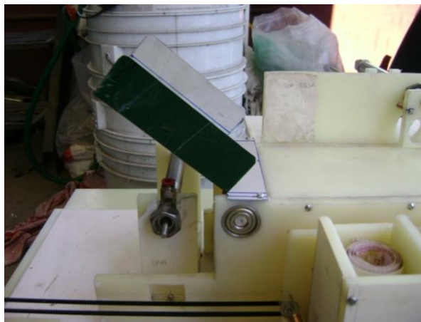
Figura 5.19. Rampa de entrada de residuo.
