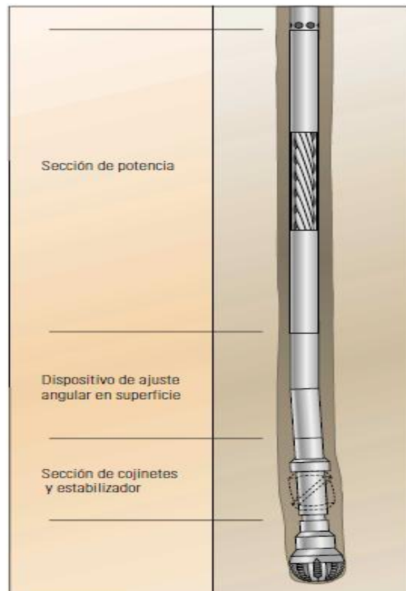
Figura 5.2. BHA direccional. El PowerPak es un dispositivo direccional simple pero resistente, compuesto por una sección generadora de potencia, un dispositivo de ajuste angular en superficie, un estabilizador y la barrena de perforación. (Oilfield Review, 2000).
