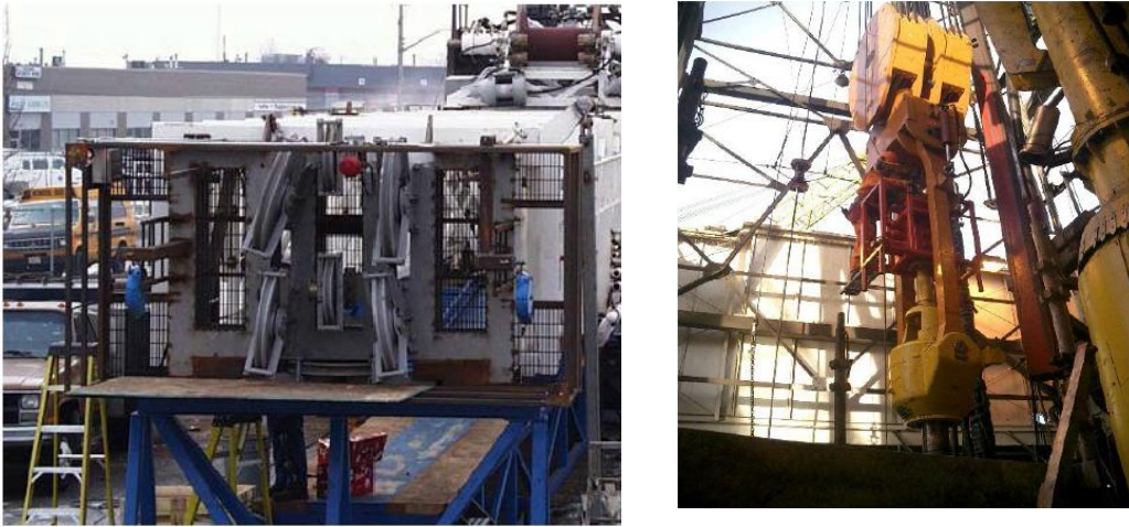
Figura 4.21. Parte del mecanismo de izaje: Corona Split (izquierda) y Polea Viajera Split con preventores de línea de acero (derecha). (OTC-17685)
