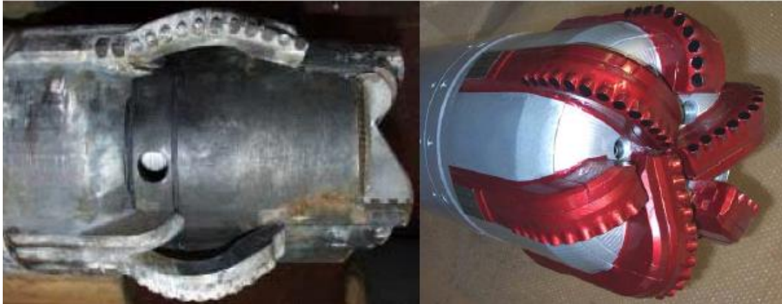
Figura 2.26. Tecnología Drilling With Casing™. Zapata perforable (derecha) y zapata después del desplazamiento, lista para la cementación (izquierda). (Cortesía Weatherford).
