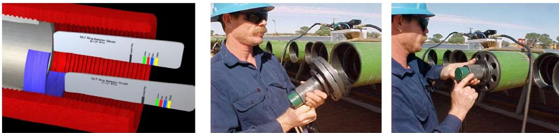
Figura 4.24. La selección del anillo se hace simplemente con una herramienta que se inserta en el extremo del acoplamiento (izquierda). La instalación es rápida y fácil con una sencilla herramienta de accionamiento hidráulico portátil. (Boletín TESCO, 65000).
