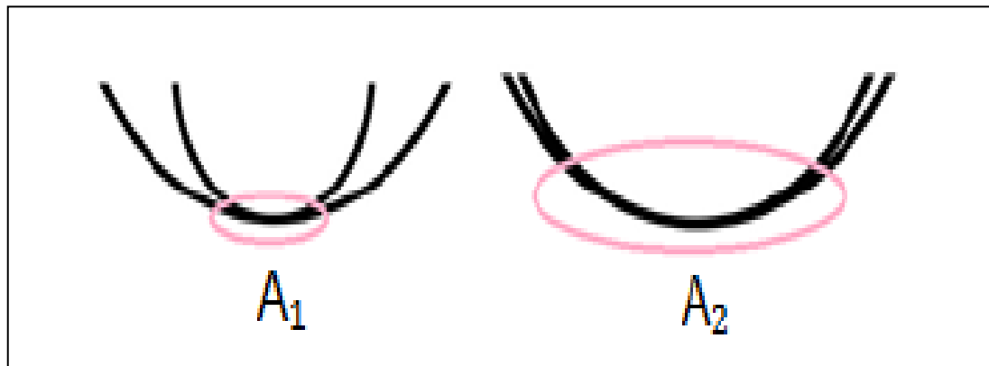
Figura 2.21 Comparación del área de contacto entre la perforación con TR (derecha) y perforación convencional (izquierda). (SPE-147102)
