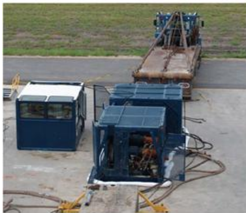
Figura 4.20. Unidad de línea de acero para las operaciones de recuperación del BHA. Ésta integrado por tres componentes, los cuales son: en la parte frontal se encuentra la unidad de tracción, en la parte posterior se cuenta con un carrete con 20,000 ft de línea de 5/8", al lado se aloja la cabina de control. (SPE-99248).
