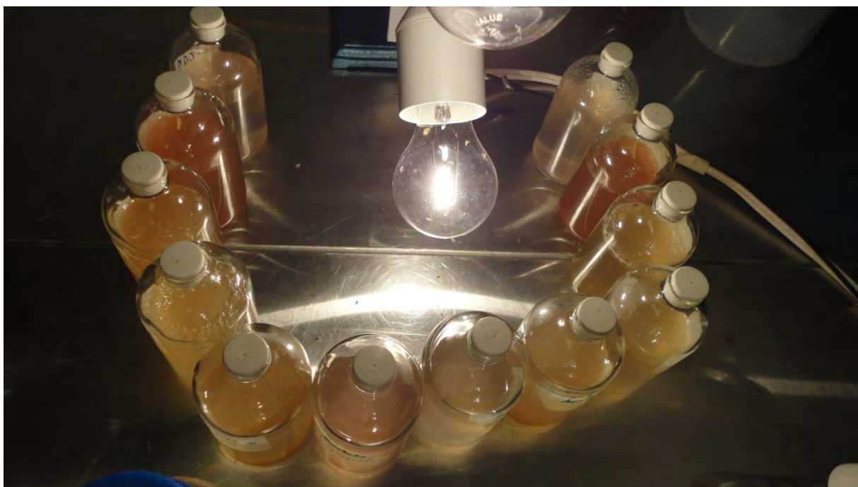
Figura 3.2. Montaje experimental para la selección del consorcio fotosintético productor de hidrógeno.
