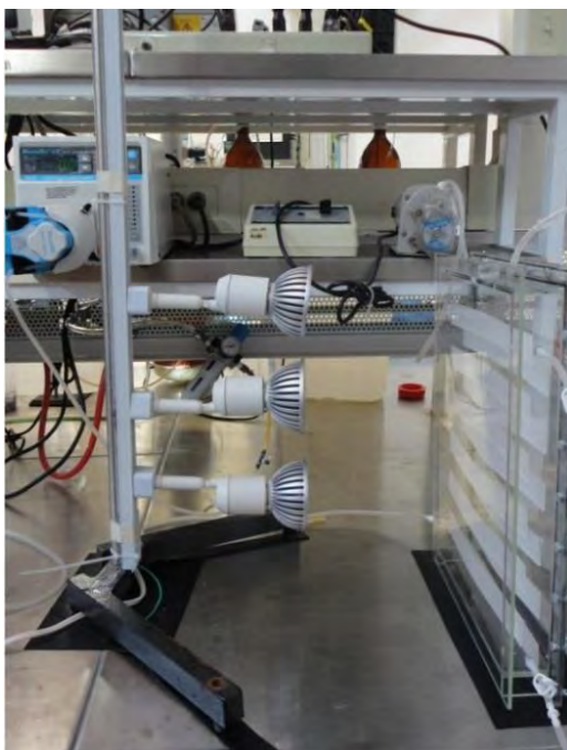
Figura 2.6. Montaje de fotobiorreactor.
