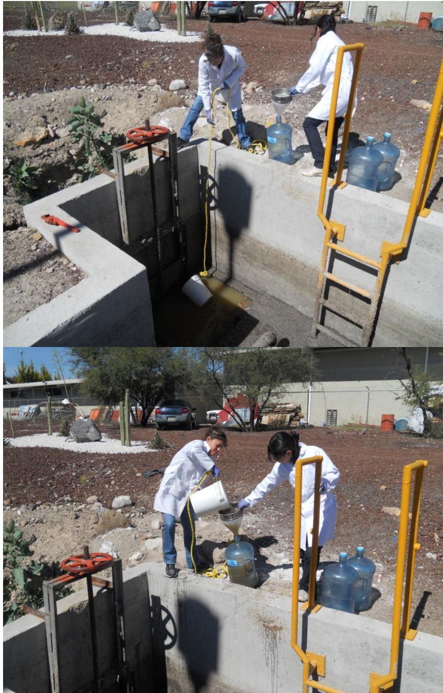
Figura 4.3 Toma de la muestra de agua residual en la entrada de la planta de tratamientos de agua residual municipal.
