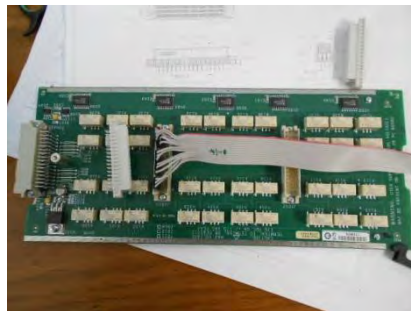
Imagen 30 Tarjeta sin el conector y con cables provisionales para la identificación y adaptación del conector
