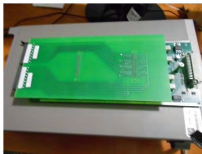
Imagen 24 Tarjeta matrix switch 7012-C con su conector de salida adaptado
