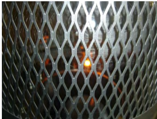
Figura93 (b) La campana con su protección haciendo vacío
