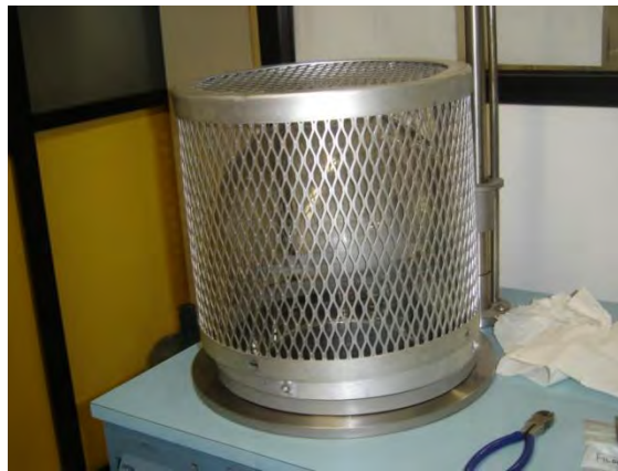
Figura93 (b) La campana con su protección haciendo vacío
