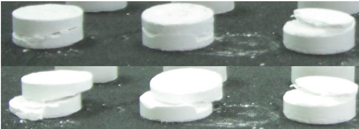
Figura 8: Compactos del Co-procesado 1. Composición 100% Di-Tab™
