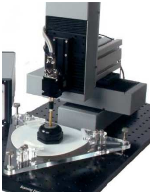
Figura 3.9. Imagen de microscopio electroquímico de barrido con sonda kelvin.
