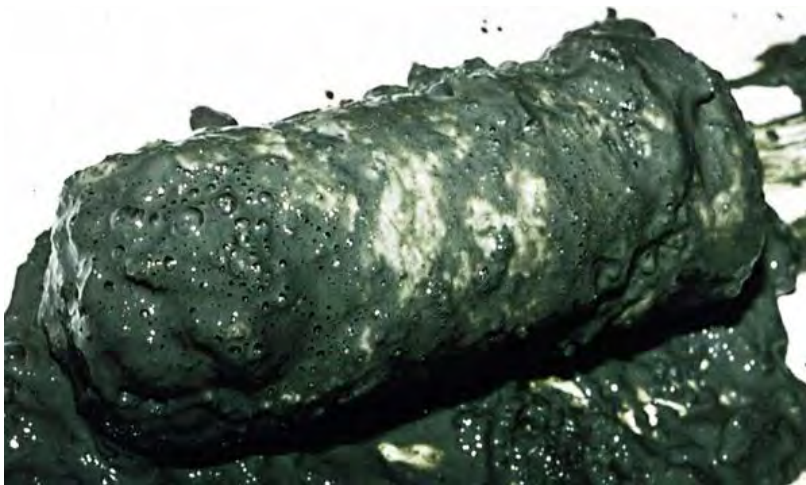
Figura 38.- Estructura en forma de tapón de hielo presente en el gas Fuente: Corrediblos de Construcción y Mantenimiento A.I.M.
