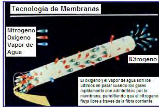
Fig. 74.- Deshidratación del gas a través de membranas permeables.
