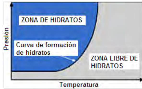
Fig.105.- Curva formación normal de hidratos dentro del ducto.
