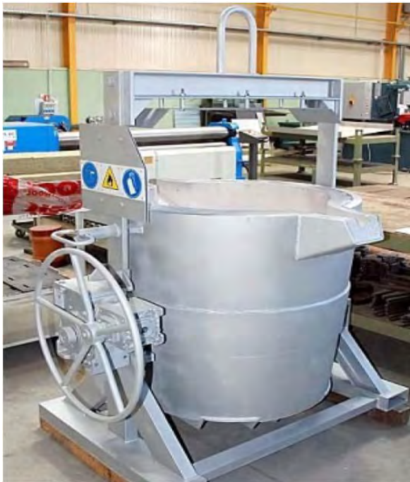
Figura 2.2. Reactor industrial para el desgasificado de aluminio.
