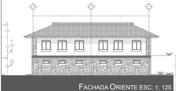
FACHADA ORIENTE ESC: 1: 125
