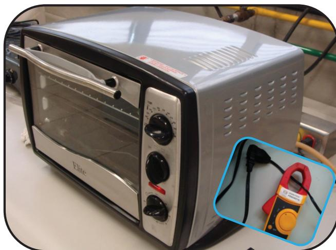
**Figura 14. Conexión en paralelo del horno con multímetro**
