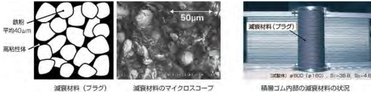
**Ilustración VIII-8.- Composición del caucho y el polvo de hierro, mostrando además el laminado con el centro de plomo del aislador de base**
