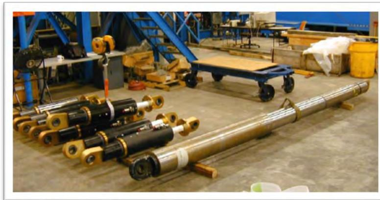
**Ilustración II-21.- Amortiguador viscoso tipo Taylor**
