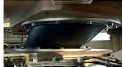
**Ilustración VIII-5.- Máquina experimental de Aisladores
