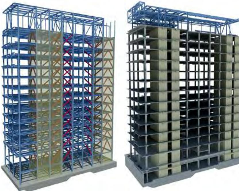
**Ilustración III-34.- Ubicación de Muros de Amortiguamiento Viscoso, en Modelos Matemáticos en 3D, durante el análisis**
