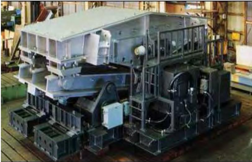
**Ilustración II-39.- Amortiguador de masa híbrido en forma de V instalado en Shinjuku Park Tower**
