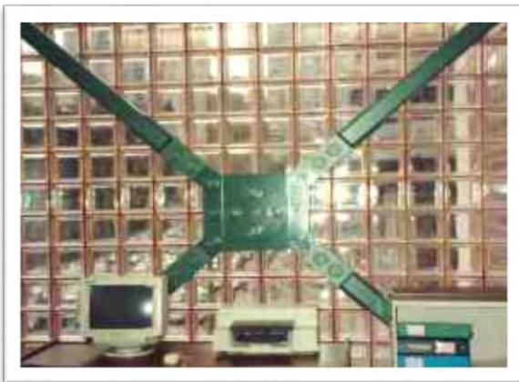
**Ilustración II-14.- Sistema Pall de Amortiguador por fricción**
