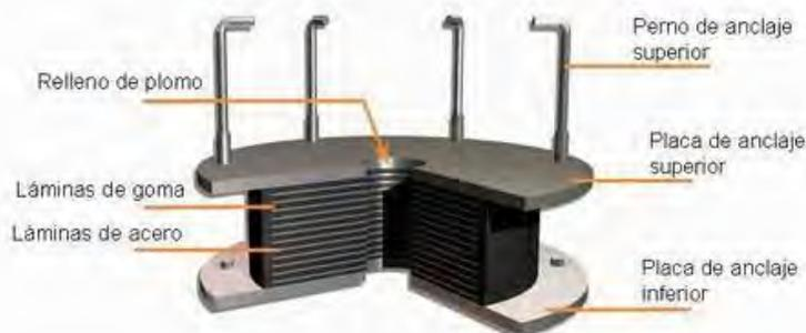
**Ilustración IV-18.- Detalles del Proyecto Edificio Colmena, en Santa Fe**
