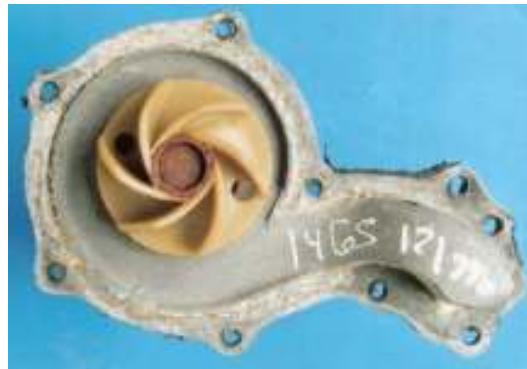
Figura 2.25 Bomba de Agua con poco Refrigerante
