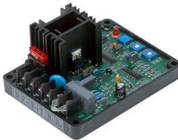
Figura 3.13 Regulador de Voltaje.
