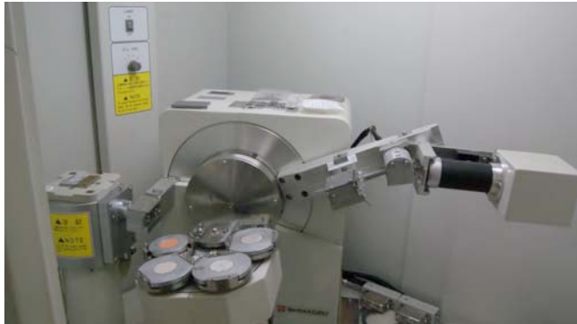
Figura 7. El equipo de Difractómetro de rayos X de marca Philips para identificar y estimar los minerales presentes
