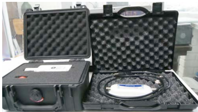
Figura 8. Equipo de medición de la susceptibilidad magnética de marca Bartington utilizado para las muestras del paleolago Las Cruces.
