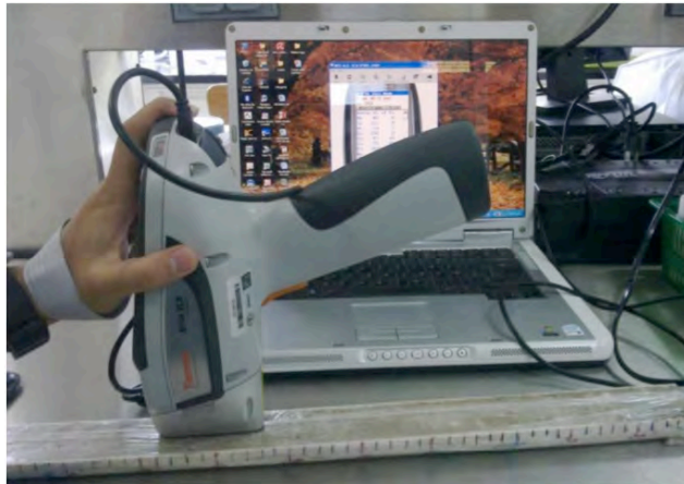
Figura 9. Equipo portátil de Fluorescencia de Rayos X portátil
