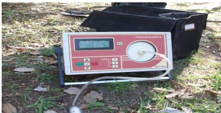
Figura 12. Foto 3. Mediciones de radón con monitor.
