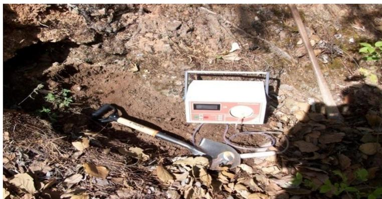
Figura 14. Foto 5. Midiendo Rn en suelos con monitor.
