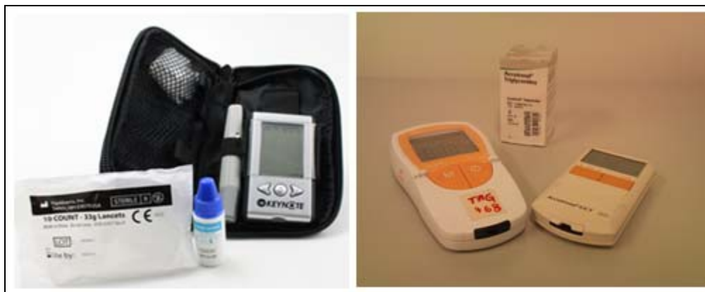
Figura 10. Glucómetro Keynote para medición de glucosa y glucómetro Accutrend Plus GCT para medición de triglicéridos.
