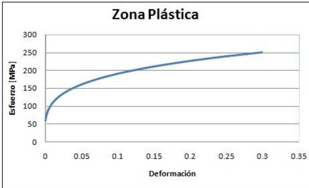
Figura 3.3. Curva para la zona plástica de la aleación SAE 783
