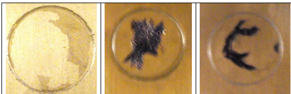
Figura 3.35. ensayos “pull-off” de probetas de A) silanos B) silanos con 0.5% de Ce y C) silanos con 0.1% de Ce
