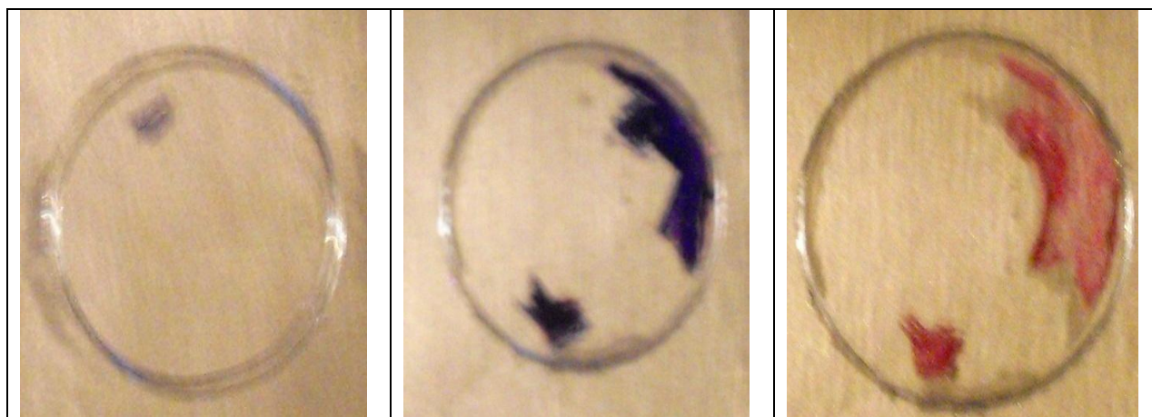
Figura 3.36. muestra ensayos “pull-off” de probetas de A) silanos B) silanos con 0.5% de Ce y C) silanos con 0.1% de Ce
