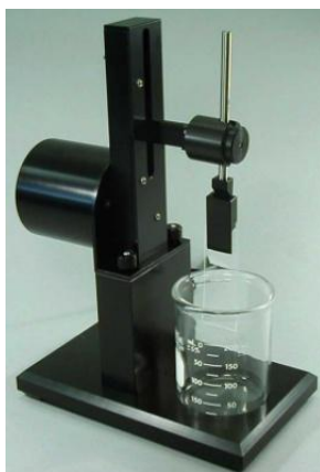
Figura 2.1. Proceso "dip coating"
