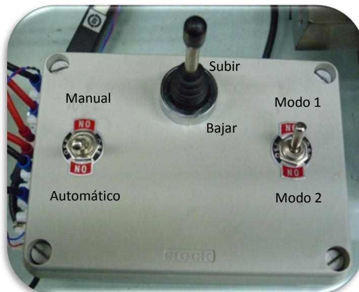
Figura 5.4. Control de posicionamiento.
