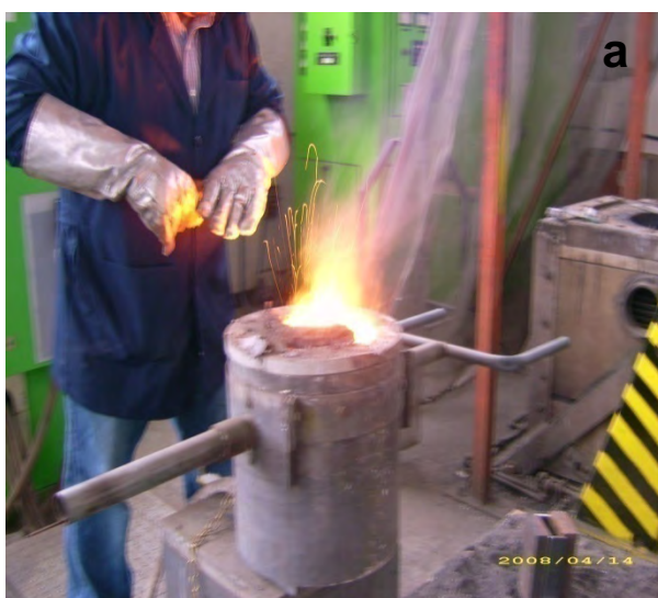
Figura 3.17 a) Obtención de las aleaciones empleando un horno de inducción electromagnética.
