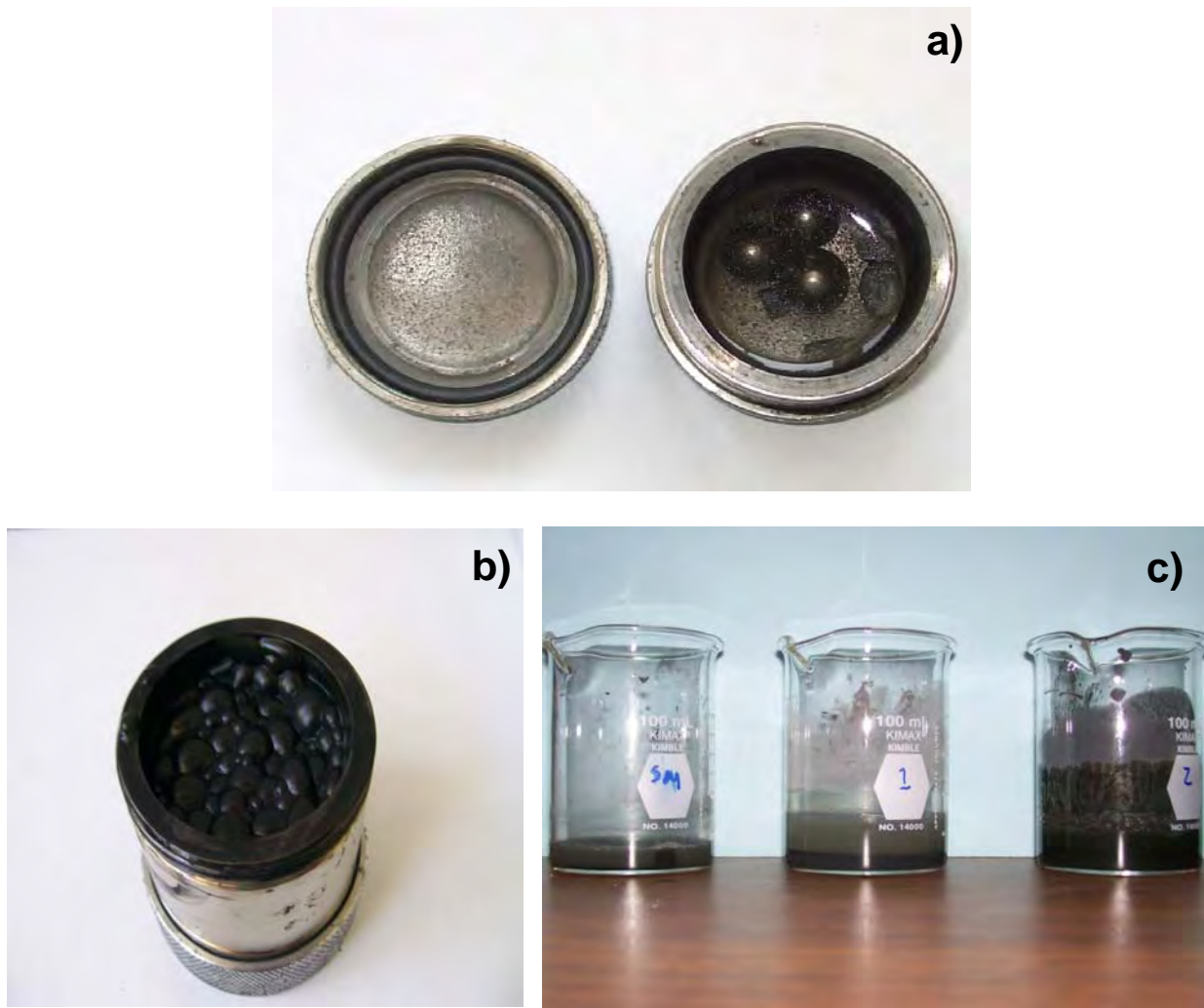
Figura 3.21 Vial con el material, las bolas y el agua antes de moler a), vial retirado del molino una vez terminada la molienda b), vasos con material listo para secado dentro de una mufla c).
