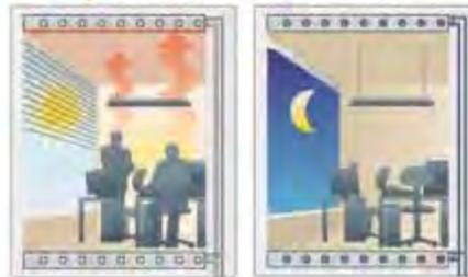
Die aktivierten Decken nehmen während der Nutzungszeit der Räume Wärme auf und kühlen so den Raum. In der übrigen Zeit geben sie die Wärme wieder ab. Wenn tagsüber hohe Temperaturen herrschen, entstehen die höchsten Antriebe für das System. Die kühlende Decke senkt den tagtäglichen Temperaturbereich zwischen 21° und 26° K. Da Wasser den Kühl- und Heizenergie zuverlässig transportiert, schwanken sich die Temperaturen nicht auf.
