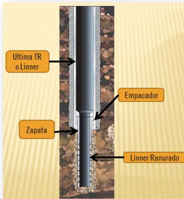
Figura 15. Terminación en tubería ranurada
