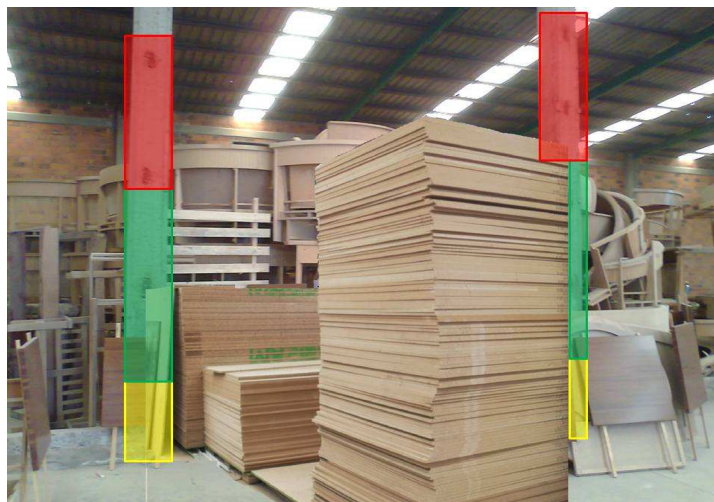
Figura 0-3 Ejemplo de Kanban en las columnas de las instalaciones
