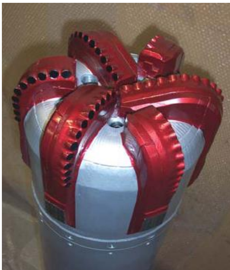
Figura 4: zapata perforadora DS 3
