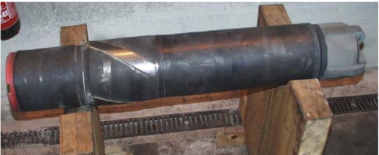
Figura 6: Estabilizador y Estructura Principal
