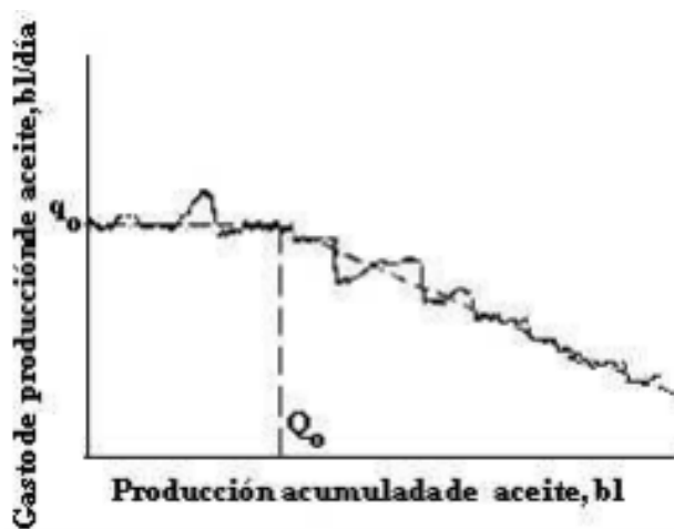
Figura2-25. Gráfica típica de gasto de aceite vs. Producción acumulada. Fuente: "Comportamiento de pozos". Análisis de la declinación.
