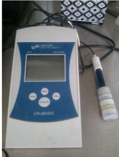
*Figura 3.4. Medidor de pH, Laboratorio de Geoquímica Ambiental.*
