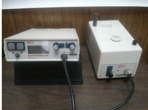
*Figura 3.6. Equipo Bartington MS2, Laboratorio Geoquímica Ambiental*
