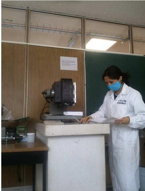
*Figura 3.10a. Utilizando el separador magnético Frantz, Laboratorio de separación de minerales.*
