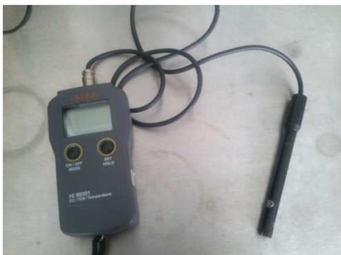
*Figura 3.5. Medidor portátil de conductividad eléctrica, Laboratorio de Geoquímica Ambiental.*
