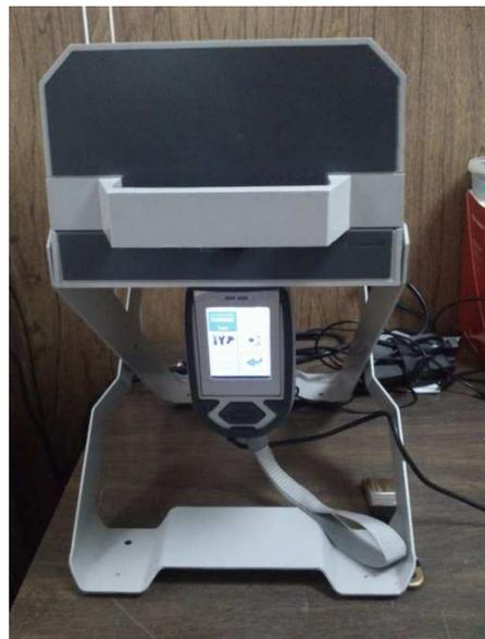
*Figura 3.7. Equipo Nitton XLt3, Laboratorio Geoquímica Ambiental*
