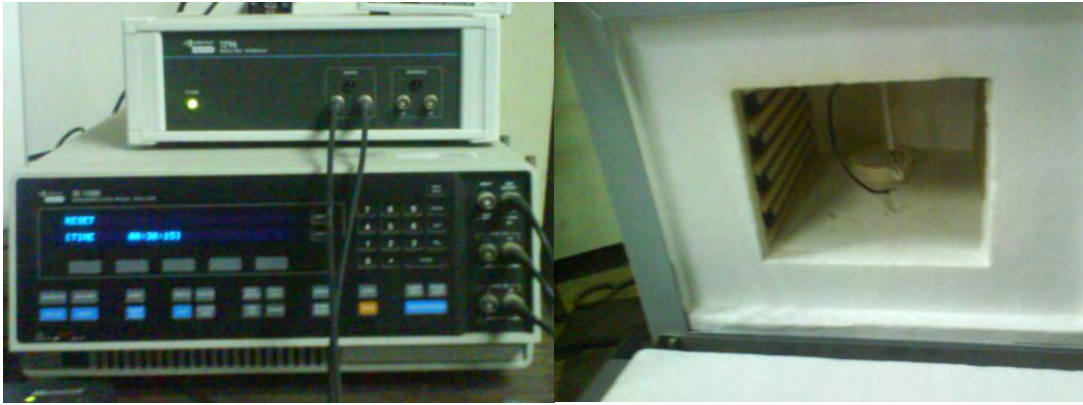
Figura 2.15 a) Solartron 1260 e interface dieléctrica 1296. b) Cámara del horno con el portamuestras.
