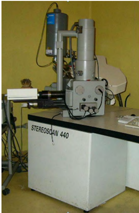
Figura 2. 6 a) Microscopio electrónico de barrido utilizado en este trabajo. b) Esquema de un microscopio electrónico de barrido.
