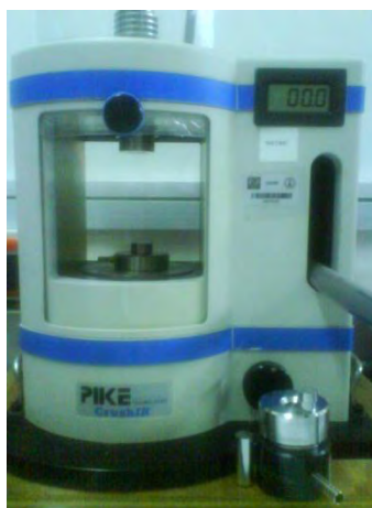
Figura 2.2. Prensa hidráulica marca Pike empleada para conformar las pastillas.
