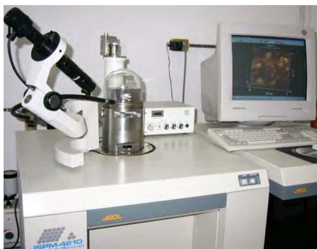
Figura 2. 8 a) Microscopio de fuerza atómica utilizado en este trabajo. b) Esquema de un microscopio de fuerza atómica.
