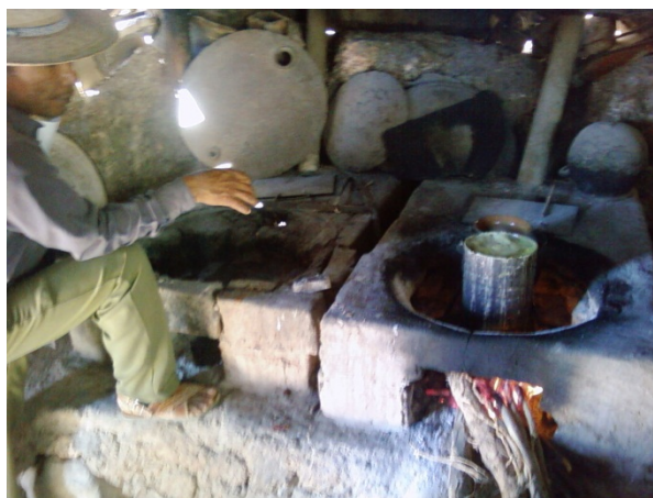
Figura 12. Estufas Patsari de una hornilla secundaria. En la foto, el técnico comunitario explica el mal funcionamiento. Tlacotla, Guerrero.
