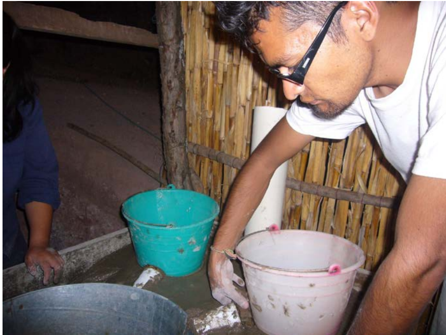
Figura 27. Construyendo el prototipo. En la imagen se puede ver los componentes que moldean la cámara de combustión, el sistema de ductos y las hornillas secundarias. Enero de 2010.
