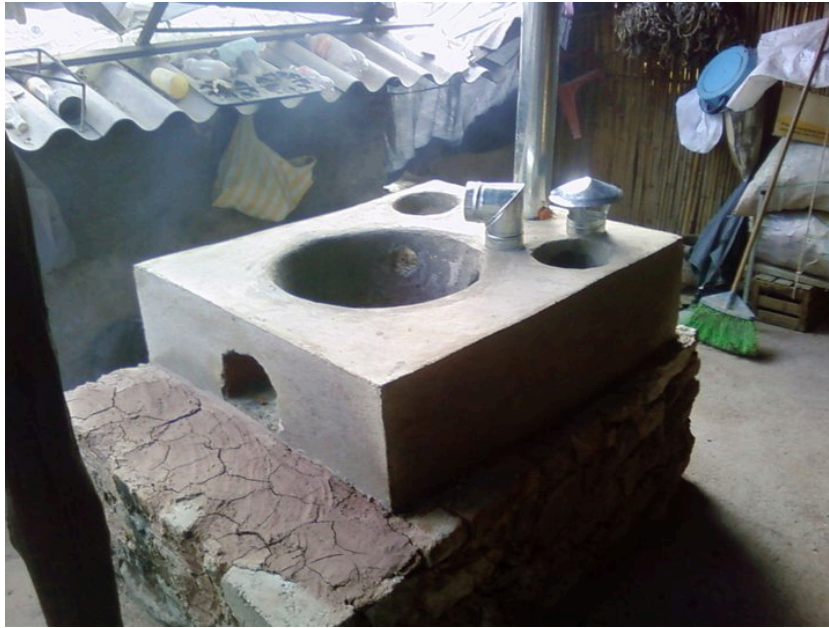
Figura 35. Estufa terminada en Xalpatláhuac y repellada con ceniza.
