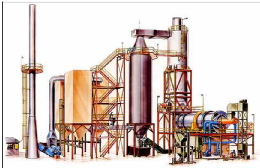
Fig. 6.4 "Incinerador de Horno Rotatorio"
