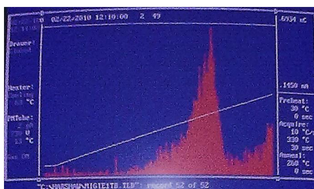
Figura 2.4. Curva de brillo de TLD-100 obtenida con el equipo lector HARSHAW 3500 del ICN-UNAM.
