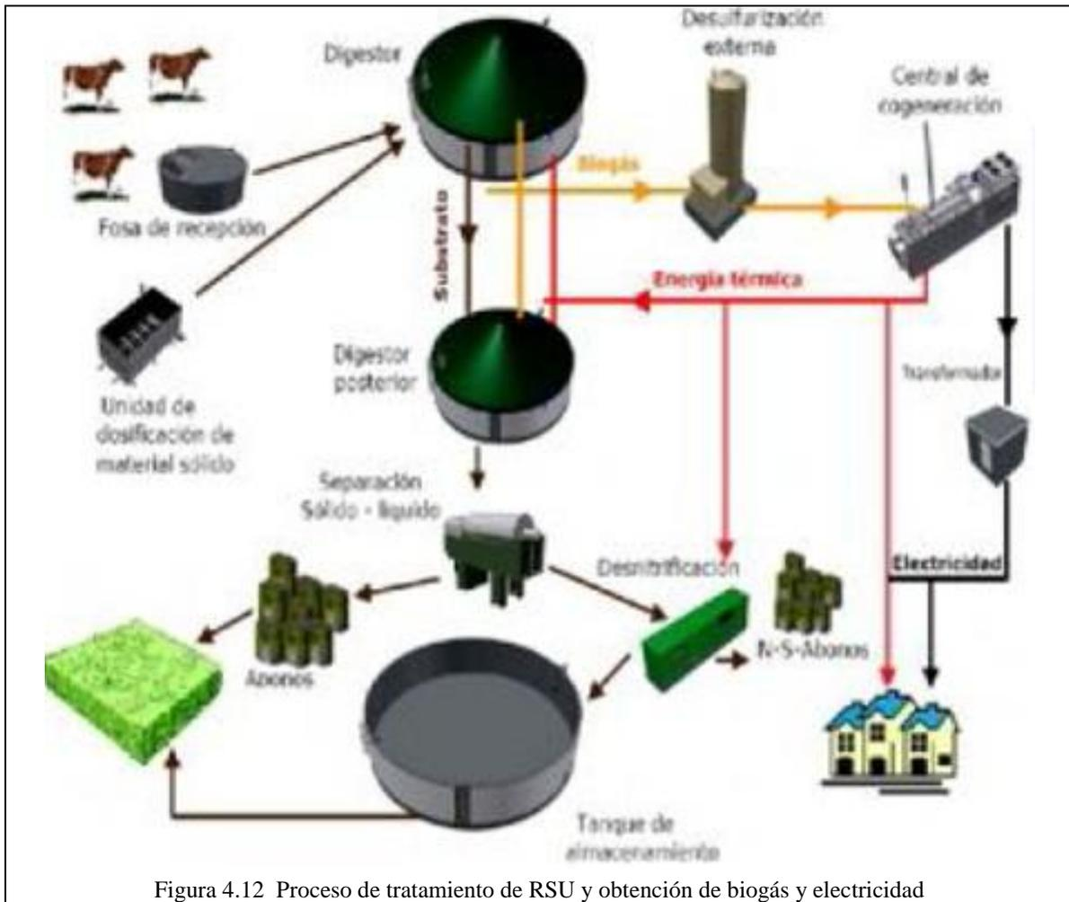
Figura 4.12 Proceso de tratamiento de RSU y obtención de biogás y electricidad
