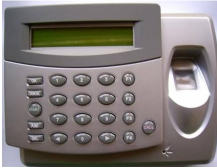
Fig. 1.9. Lectora biométrica de control de acceso por huella digital.
