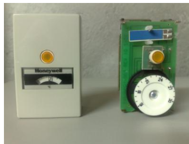
Fig. 1.3. Elemento sensor de temperatura
