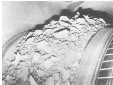
**Imagen 2.10 Material descargado desde la polea principal del conveyor**
