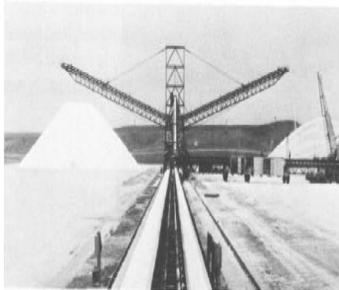
**Imagen 2.12 Apilador de doble ala descargando a pilas de almacenaje hacia ambos lados del conveyor alimentador**
