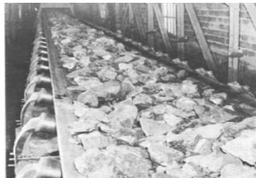
**Imagen 2.1 Conveyer de 54 pulgadas de ancho con inclinación**
