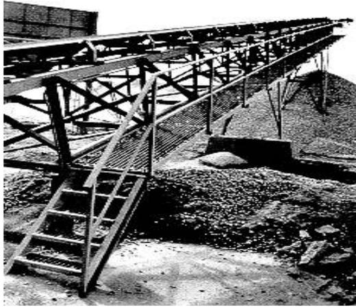
**Imagen 1.15 Descarga y apilado de material a partir de la polea terminal**
