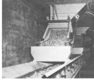
**Imagen 2.8 Alimentadores múltiples en túnel debajo de pilas de almacenamiento**
