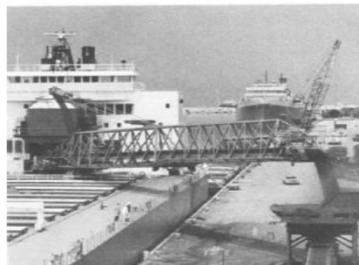
**Imagen 2.14 Barco auto-descargante con transportador de 78 pulgadas de ancho**
