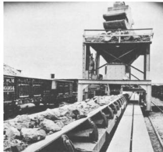
**Imagen 2.7 Tolva sobre rieles con alimentador cargando a lo largo de la longitud del material**
