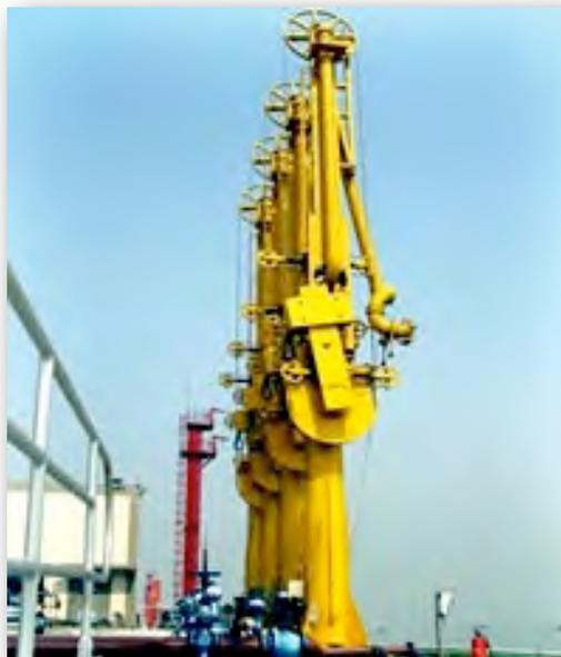
*Figura 43: La línea de producto reposa sobre una columna vertical y está compuesta por un brazo interno y un brazo externo estos dos brazos son piezas móviles. El equilibrado es necesario debido al peso de los tubos.*
