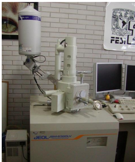
Figura 47. Microscopio Electrónico de Barrido de la Unidad de Biotecnología y Prototipos utilizado durante esta investigación
